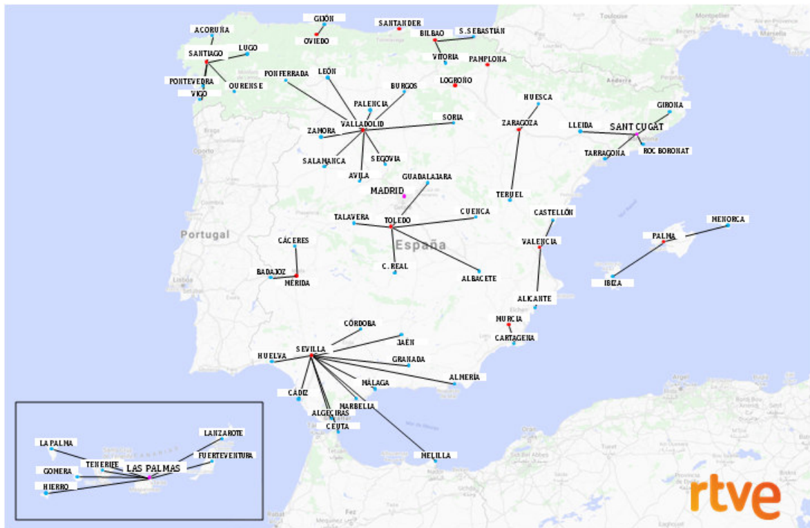
Diagrama de conexiones de los transmisores con sus centros
