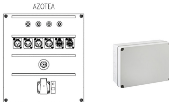
Figura 4. Caja de Azotea y cajetín estanco
