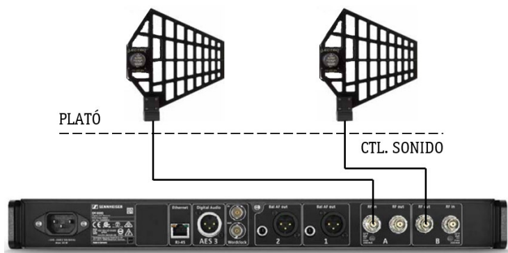
Figura 1. Interconexión de antenas – receptor de microfonía inalámbrica
