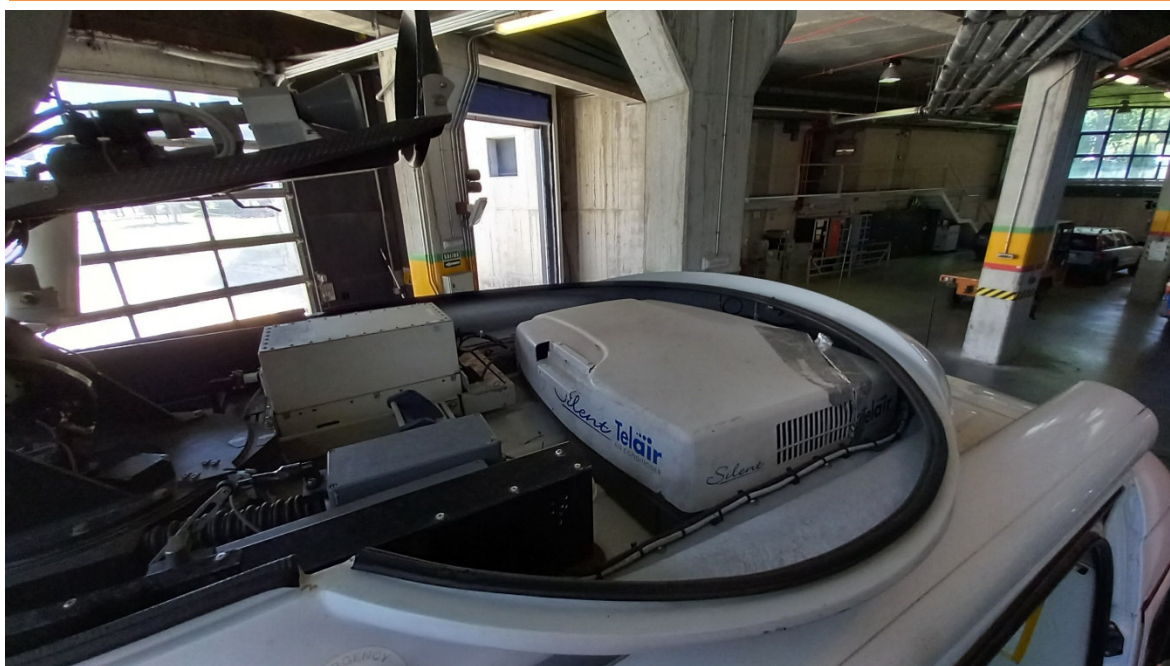
Figura 3: detalle de la unidad exterior donde va alojada
