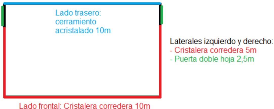
1. Un lateral frontal de 10m con cerramiento corredero de cristal de 10mm o superior sin perfiles.
